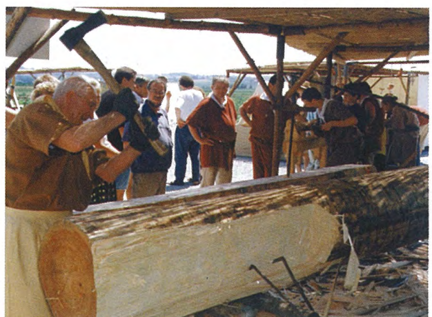
Nicht nur Militärisches, auch Handwerkliches gab es auf dem Kastellfest 1999 zu sehen. Ein Zimmermann machte aus einem vier Meter langen Fichtenstamm eine Dachrinne – bei 36 Grad!
